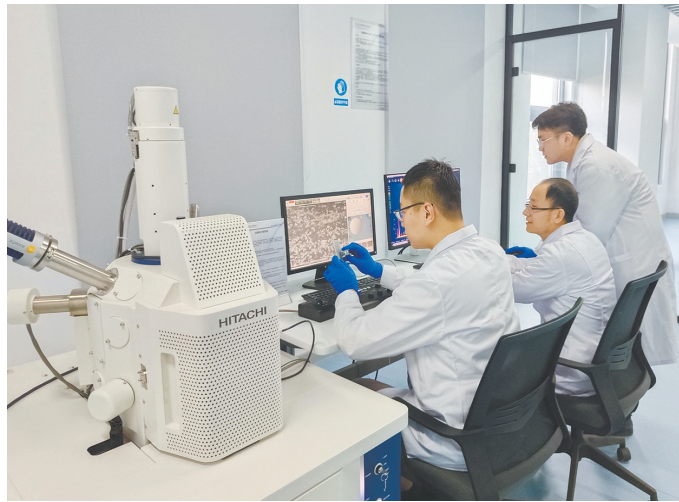
西安汇创科研人员利用扫描电镜观测银粉粒径
